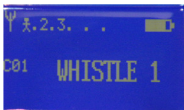
Numéro de canal, numéro de sifflet, charge batterie et nombre de terminaux dans le réseau
